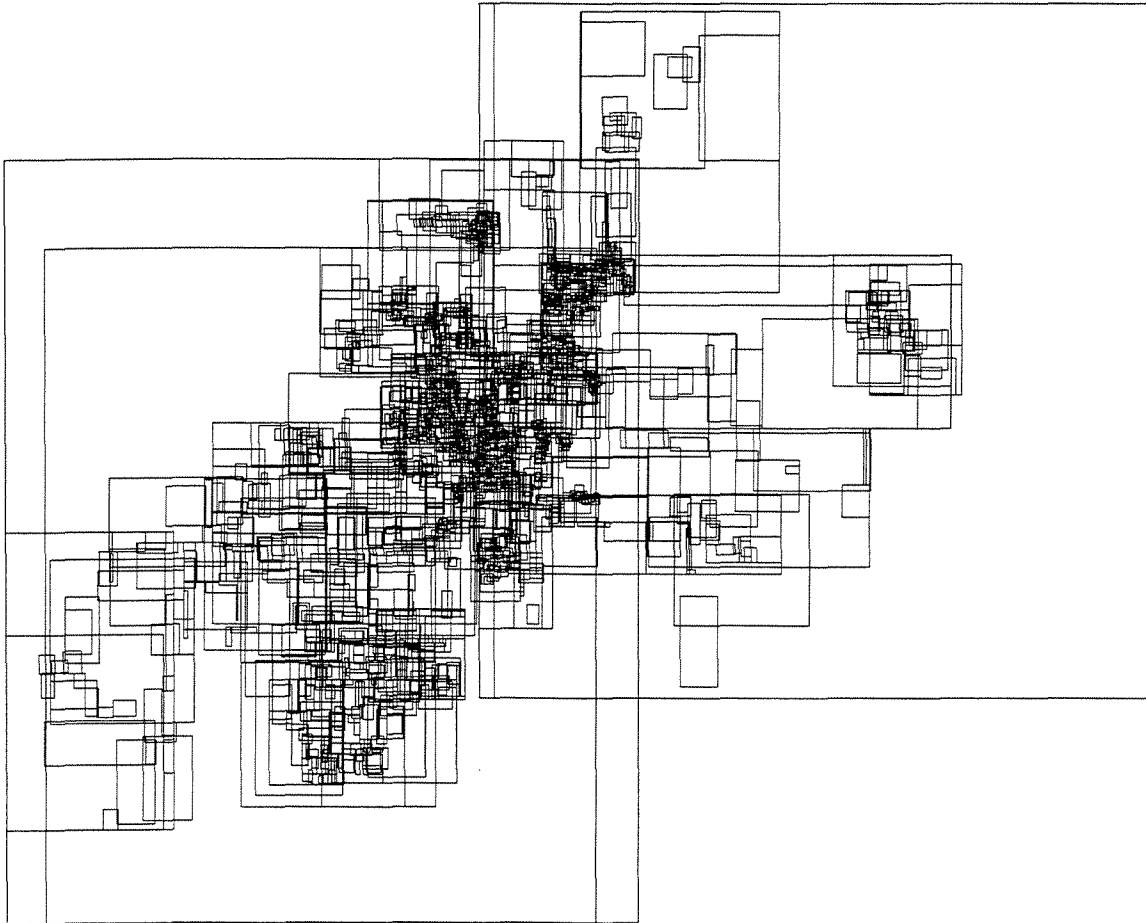
Figura 4.16: MBRs internos correspondentes ao nível 3 do índice gerado com páginas de 2 kbytes, para o conjunto cidade .
